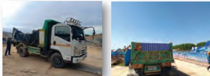
การปิดคลุม หรือผูกมัด วัสดุรอบบรรทุกวัสดุก่อสร้าง
